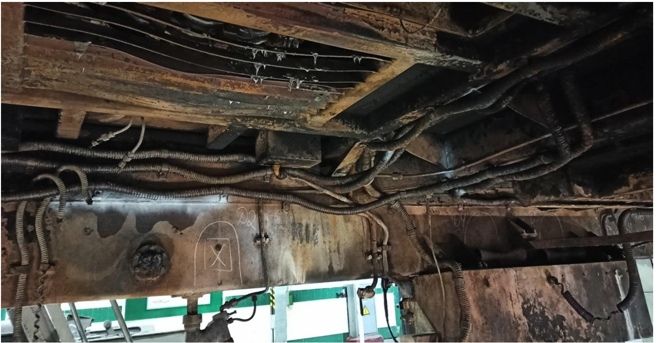
Рисунок 1.4 – Технічний стан рами кузова електровоза ЧС4 №204 після пожежі
