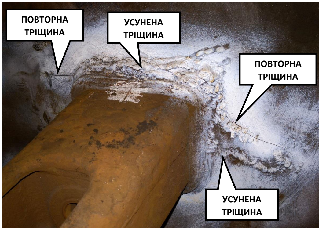
Рисунок 5.2 – Тріщини у рамі візка локомотива ТЕП 70, що виникли повторно у зварних з'єднаннях раніш усунених тріщин
